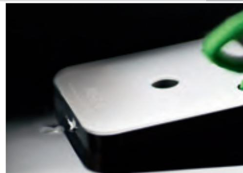
Lametta con raggio ottimale sul bordo anteriore semplifica il puntuale taglio dei grani di polvere. L'esecuzione in metallo duro la rende estremamente duratura e con una lama affilata a lungo.
